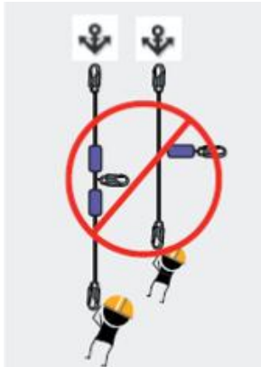
Ilustración 7: Riesgo de utilización incorrecta de una eslinga
