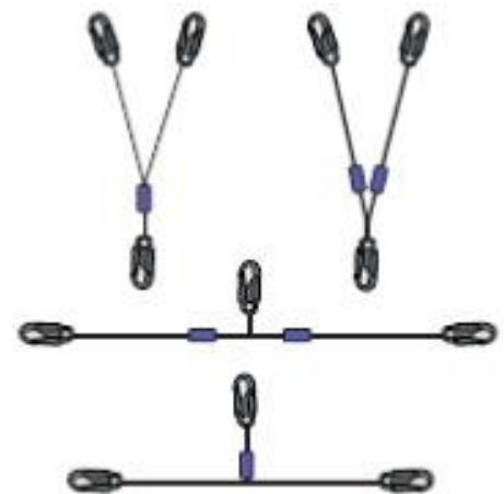
Ilustración 11: Eslingas en “Y” y “V” de misma dimensión y amplitudes distintas.
