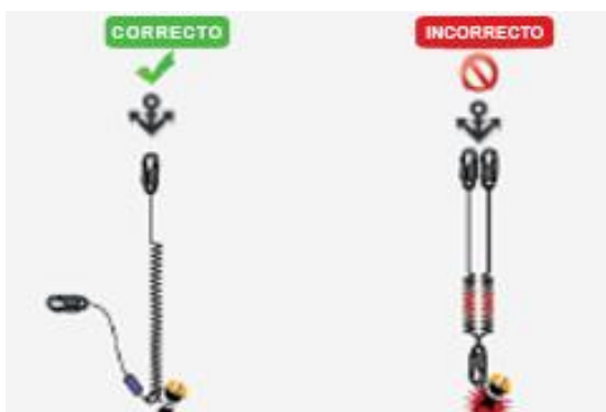
Ilustración 12: Forma correcta e incorrecta de uso de la eslinga en “V”
